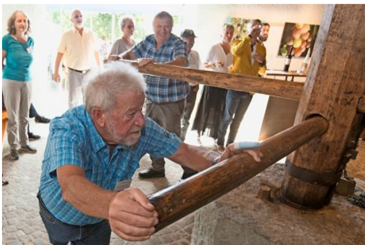
Mit dem Drehkreuz wird der Pressbalken in die richtige Position gebracht.
